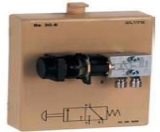
**الغرض:** يقوم بمنع سريان تيار الهواء المضغوط في الوضع العادي وفي نفس الوقت يسمح بتفريغ الهواء من اسطوانه العمل من الوضع (A الى R).
